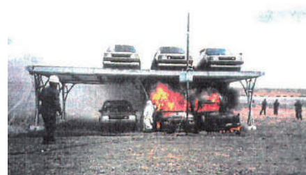
設立当初に工業会が実施した実大火災実験
